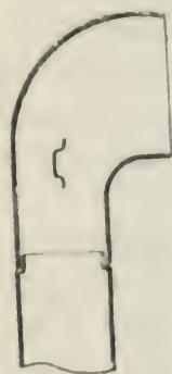
Fig. 110. — Schéma de l'extrémité supérieure d'une manche en tôle avec son pavillon mobile.
